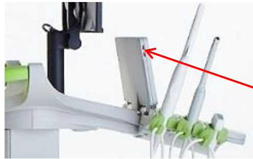
7. ábra: Az érintőképernyő bal oldalán található USB-csatlakozók
