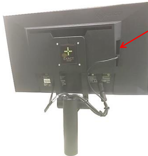
8. ábra: A monitor hátulján található USB-csatlakozók (csak bizonyos ExactVu-rendszerkonfigurációk esetén állnak rendelkezésre)
