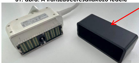
32. ábra: Zárható transzducercsatlakozó-fedél
