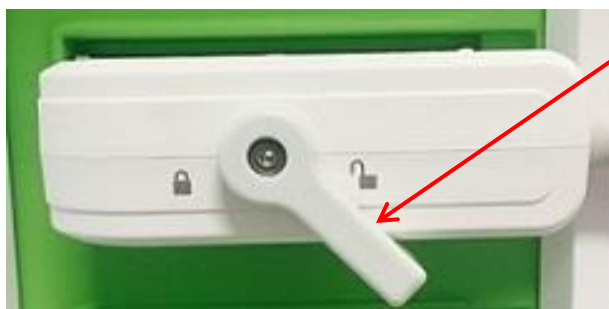
30. ábra: A transzducercsatlakozó rögzítógombja kioldva
