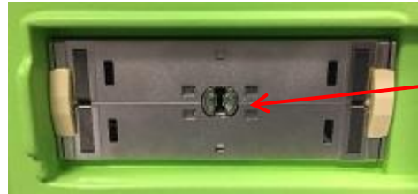
20. ábra: A transzducer-csatlakozóaljzaton lévő reteszelőnyílás
